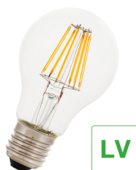
145609 LED FIL A60 E27 12V-24V AC/DC 6W 690lm (53W) 827 Clear
