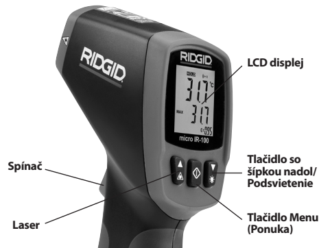
Obrázok č. 8 – Tlačidlá/Displej prístroja micro IR-100
