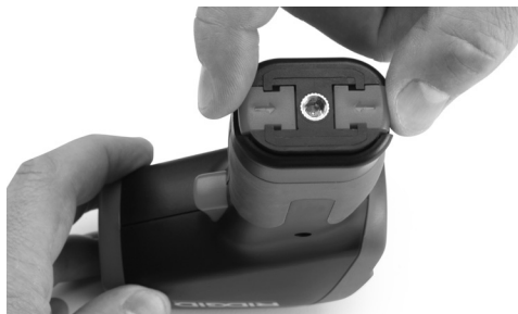
Figura 4 – Rimozione del comparto della batteria
