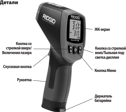
Рис. 2 – Детали прибора micro IR-100
