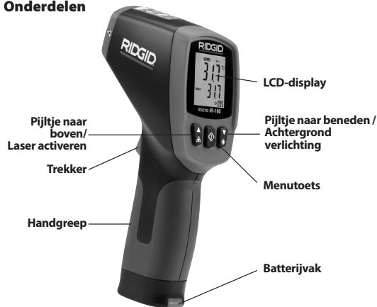
Figuur 2 – Onderdelen van de micro IR-100
