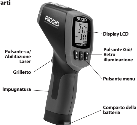
Figura 2 – Parti del micro IR-100
