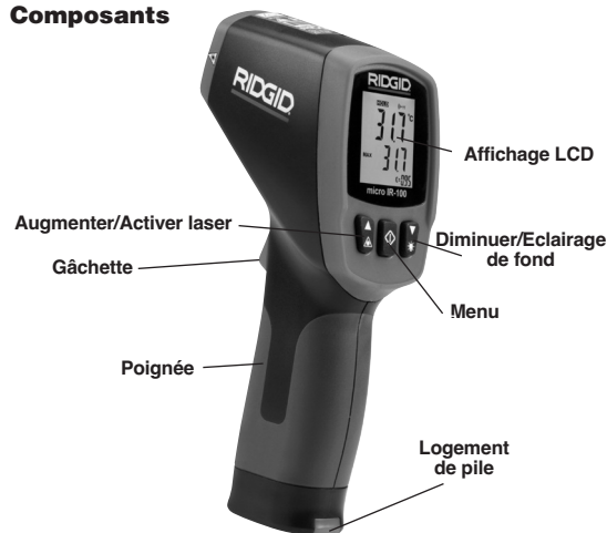
Figure 2 – Composants du micro IR-100
