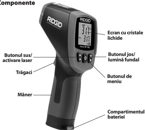
Figura 2 – Componentele micro IR-100
