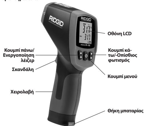
Εικόνα 2 – Εξαρτήματα του micro IR-100
