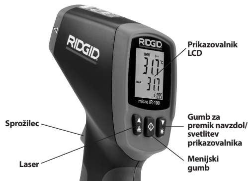
Slika 8 – Prikazovalnik in gumbi instrumenta micro IR-100
